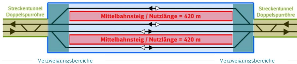
Abbildung 89: Schema Station mit einer zweigleisigen Tunnelröhre
