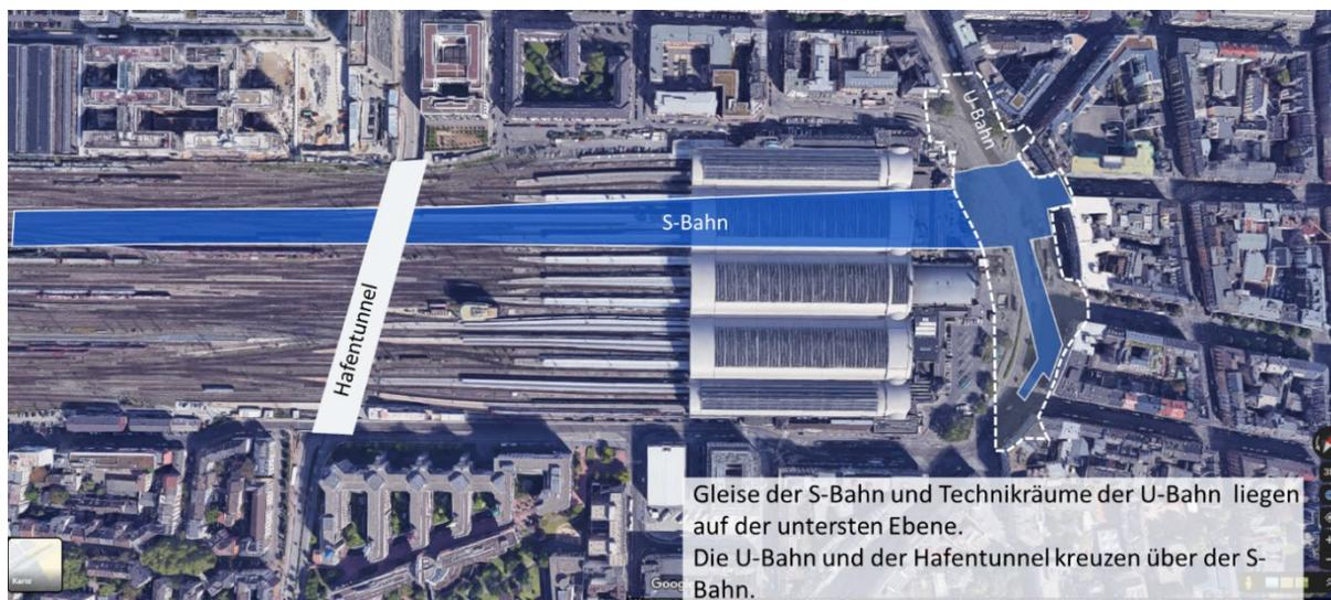
Abbildung 40: Lage S-Bahntunnel im Bahnhof und Gleisfeld
