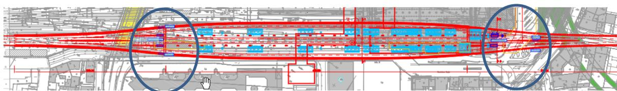
Abbildung 80: Übersichtslageplan Stationsvariante in offener Bauweise, Entrauchung, Nottreppenhäuser
